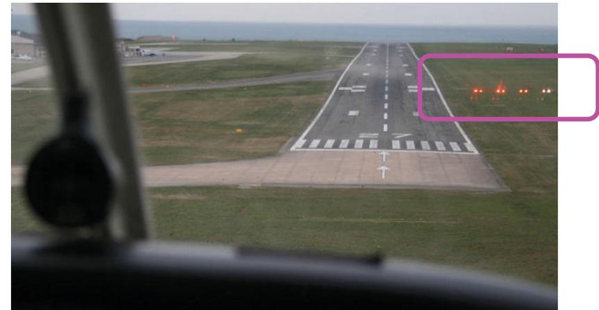
PAPI-Anzeige bei zu niedrigem Anflug (3x rot) aus Sicht des Piloten
