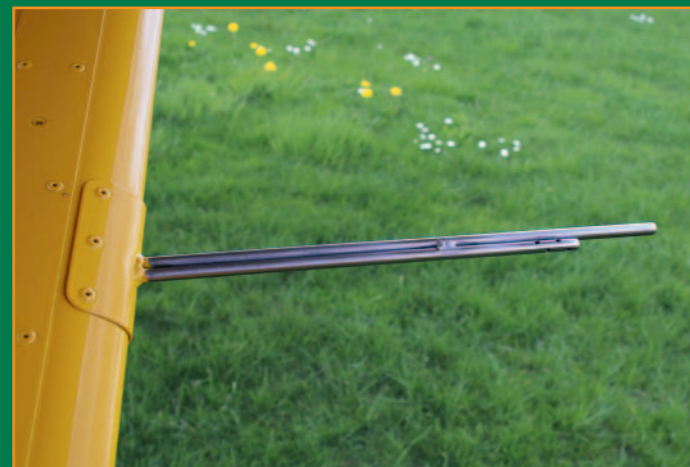
Pitot-Rohr für statischen und dynamischen Druck: der Einfachheit halber an der Flügelstrebe montiert
