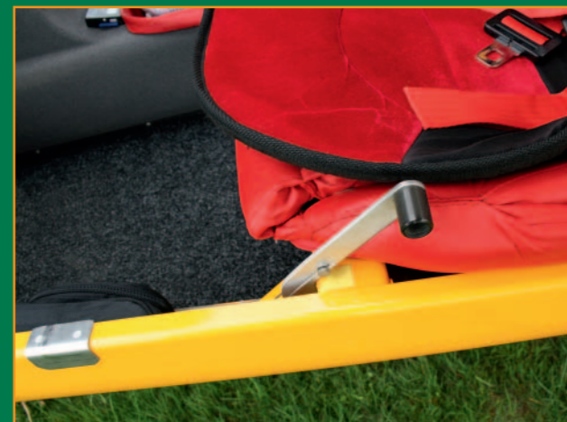
Schlicht und funktional: Gashebel am linken Kabinenrand, rechts ist ein zweiter montiert
