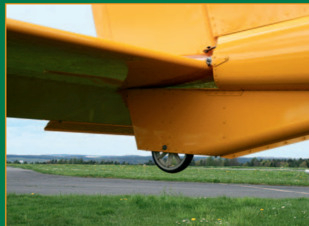
Bugrad- oder Spornradflieger? Am Heck der AeroPrakt ist für Landungen mit großem Anstellwinkel ein Rumpfschutz angebracht. Das Bugrad hat eine GFK-Blattfeder
