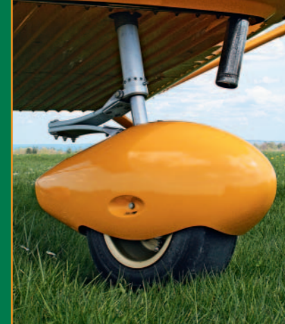
Bugrad- oder Spornradflieger? Am Heck der AeroPrakt ist für Landungen mit großem Anstellwinkel ein Rumpfschutz angebracht. Das Bugrad hat eine GFK-Blattfeder
