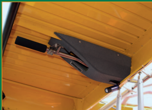
Robuste Mechanik: Klappenhebel am Kabinendach, darunter eine Cockpitlichte für marginale Lichtverhältnisse
