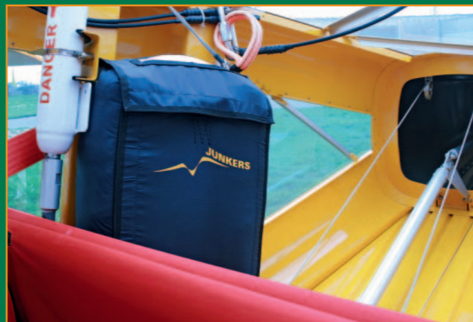
Durchblick nach hinten: Im Heck ist der Rumpf an drei Seiten verglast, rechts hinter dem Gepäckfach das Rettungssystem
