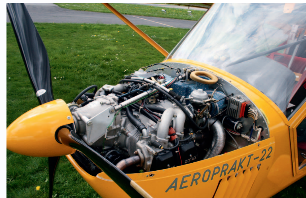
Bewährter Antrieb: Rotax 912 ULS hier ausgestattet mit Vergaservorwärmung und Airbox (blau). Der Dreiblatt-Propeller von Kievprop besteht aus CFK/GFK
