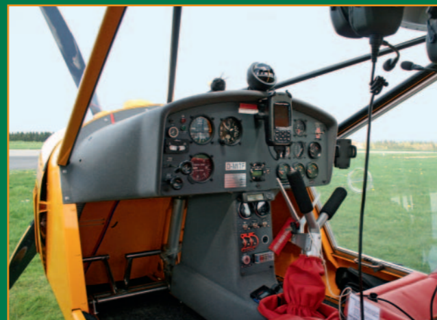
Wie im Heli-Cockpit: Verglaste Türen sorgen für perfekte Rundumsicht. Panel und Mittelkonsole sind übersichtlich gestaltet, die Tankuhren (Mitte, oben) erinnern an Pkw-Anzeigen
