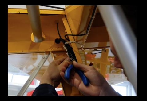
Trennen der Anschlüsse für Pitotrohr und statischen Druck, Trennender Elektrik für den Tankgeber und die Kraftstoffleitung (Blindstopfen!)
