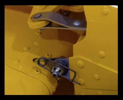
Splint und Sicherungsnadeln am Höhenruder entfernen.
