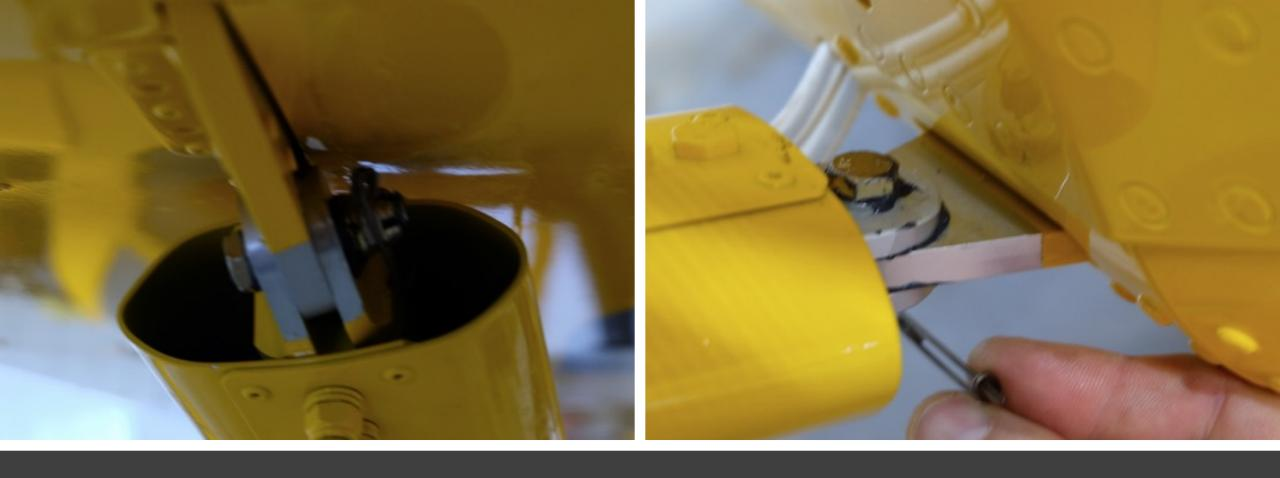
Sicherungsnadeln an den Streben entfernen.
