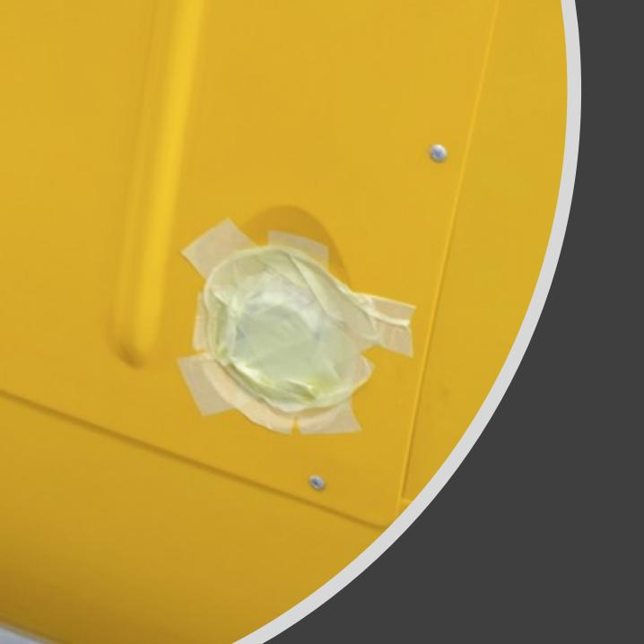
Tankdeckel entfernen, Tanköffnung abkleben (damit nix reinfallen kann!) Natürlich das gleiche auf der anderen Seite. Bei der Montage – man beachte die beiden Beilegscheiben (die Anzahl so wählen, dass die Fokkernadel gut passt), Bolzen immer von vorne nach hinten!
