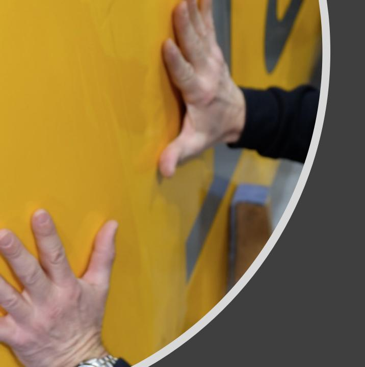
Achtung, die Fläche nicht an der Bespannung greifen, nur am Flügelende und dort wo Spanten sind!!
