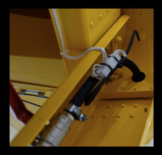
Trennen der Anschlüsse für Pitot-Rohr und statischen Druck, Trennen der Elektrik für den Tankgeber und die Kraftstoffleitung (Blindstopfen!)
