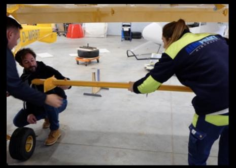
Entfernen der Strebenbolzen und Abbau der Strebe.
