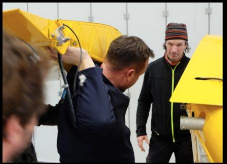
Entfernen der Hauptbolzen des Flügels, Flügel vorsichtig entfernen.
