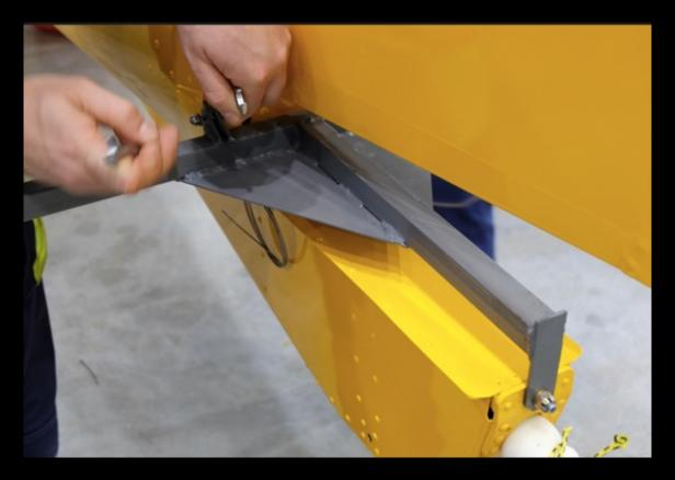
Montage der Höhenleitwerkshalterung. Schrauben des Höhenleitwerks, da wo sie hingehören.
