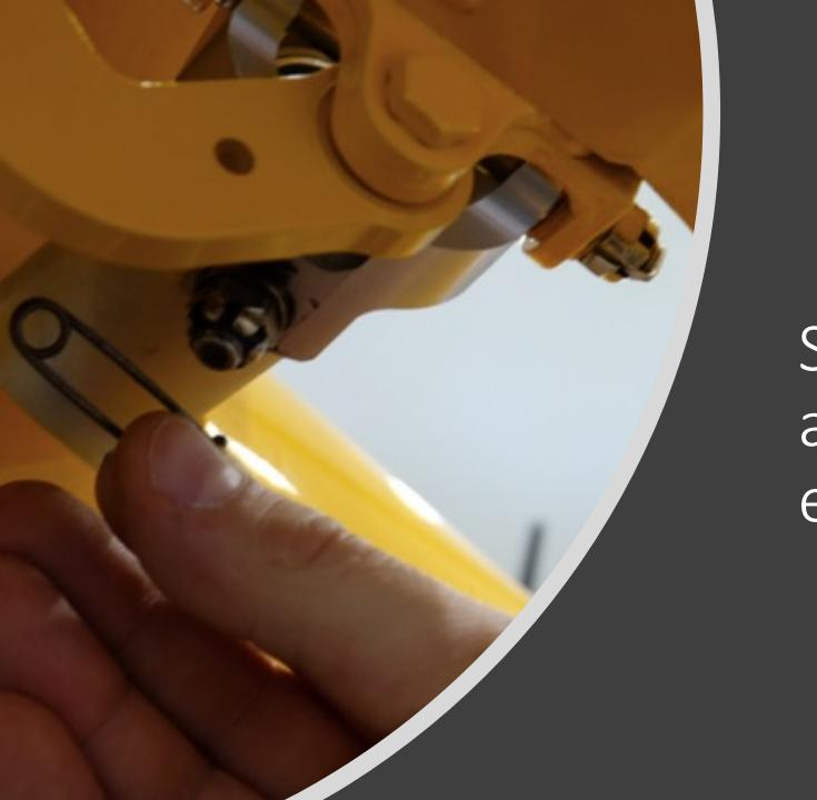
Sicherungsnadeln an den Klappen entfernen
