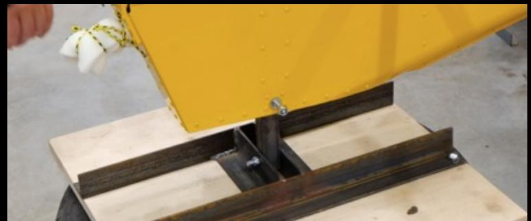
Halterungen hinten. Cockpit mit Folie einpacken.
