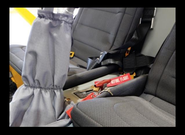
Knüppelsicherung entfernen, Knüppel auf die gegenüberliegende Seite des Flügels der abgebaut werden soll!
