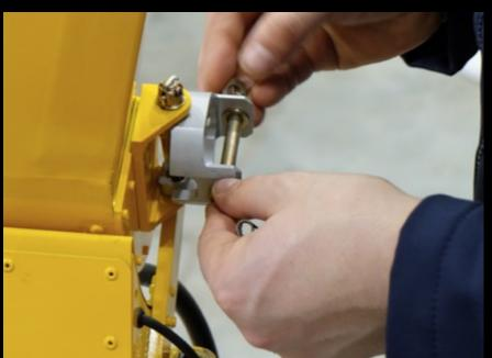
Schrauben, soweit möglich, immer "aufräumen"! Auf die Anzahl der Beilegscheiben achten! Es gibt dünne und Dicke Beilegscheiben – die Anzahl so wählen, dass die Fokkernadel / der Splint gut past!
